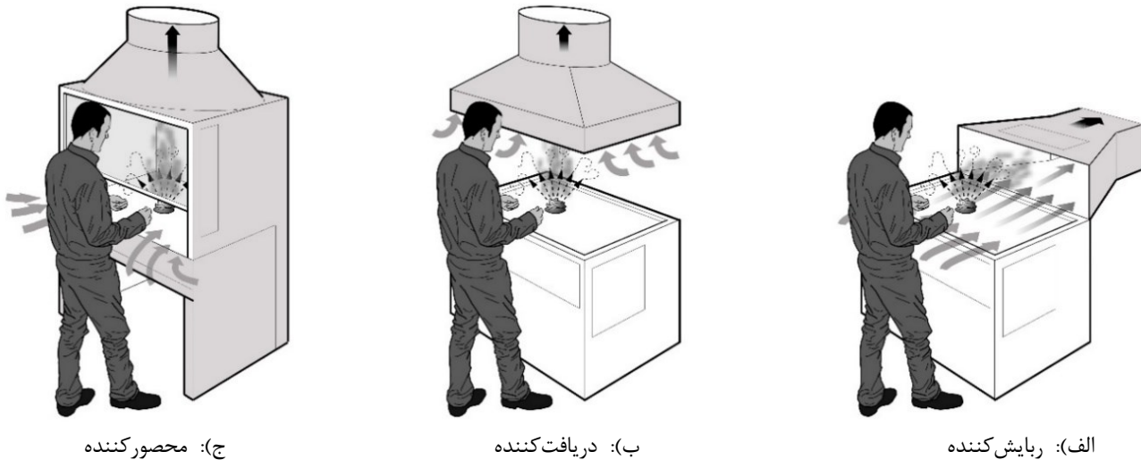
شکل ۱: انواع هود از نظر عملکردی
